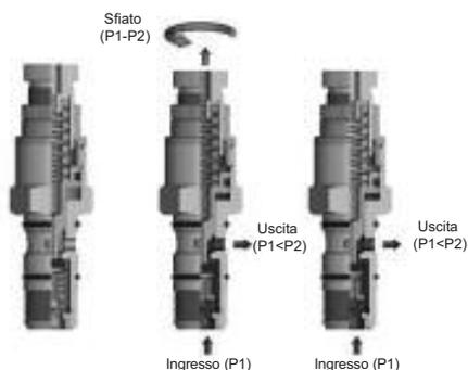
Installati in un circuito pneumatico permettono di regolare la pressione di lavoro delle attrezzature collegate, mantenendo tale regolazione costante nel tempo.
