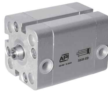
Serie di cilindri compatti a norme europee UNITOP. Il tubo di nuova generazione presenta scanalature che consentono il montaggio del finecorsa magnetico direttamente sul tubo stesso senza dover utilizzare ulteriori staffe; questo fa sì che il sensore magnetico non sporga oltre il profilo del tubo. I paracolpi elastici sono sul pistone. Solo versione con pistone magnetico. Possono essere applicati uno o più sensori magnetici.
